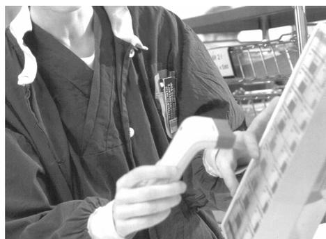
**sistemi informatizzati:** permettono di monitorare e gestire l'intero processo di sterilizzazione, (attività delle lavastumenti, termosaldatrici e autoclavi a vapore) con strumenti informatizzati (quali lettori codici a barre/scanner manuali, server, monitor e relativa tastiera, stampanti, targhette/cartellini con codici a barre per presidi ed operatori, software specifico), solitamente usati in una centrale di sterilizzazione
