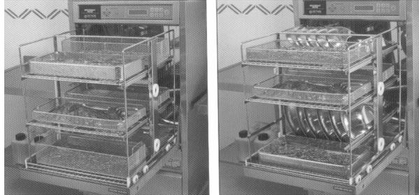
Le macchine lavastrumenti, che raggiungono temperature di lavaggio superiori a 90°C, offrono il vantaggio di associare l'attività di detersione ad un processo di disinfezione termico.
